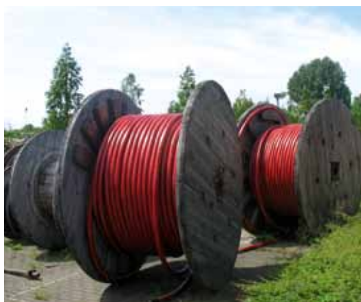
Middenspanningskabel op haspel
